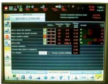
Fig. 1 - Con la vite Maxi Melt è stato possibile ottenere un risparmio energetico dell'8,6% rispetto al processo con la vite 3 T (Foto: Lameplast)
