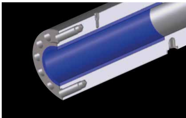
Reparatur durch teilweises Ausbuchen
