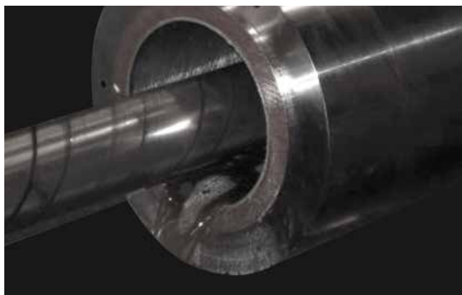
Reparatur durch einen größeren Innendurchmesser
