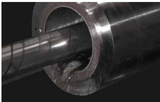
Reparatie door de binnendiameter op te honen
