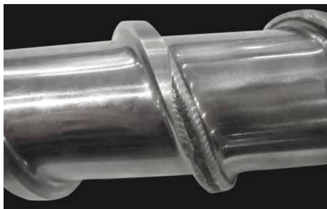
Bovenkant van de windingen oplassen
