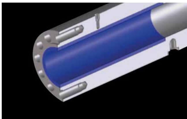
Reparatie door het aanbrengen van een nieuwe bus
